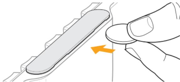
シグネチャープレートを取り外すには、指の爪、コイン、薄い器具などをリップの下から入れて取り外します。
