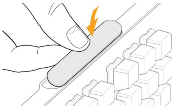
Чтобы установить табличку для подписи, закрепите верхнюю часть таблички в корпусе, а затем нажмите на оставшуюся часть пластины.
