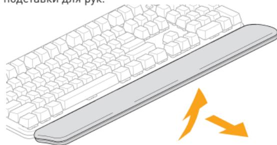
Поместите ее на алюминиевой перфорированной нижней части, выбрав одну из двух опций для регулировки размеров.
