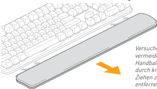
*Versuche zu vermeiden, die Handballenauflage durch kräftiges Ziehen zu entfernen.*
