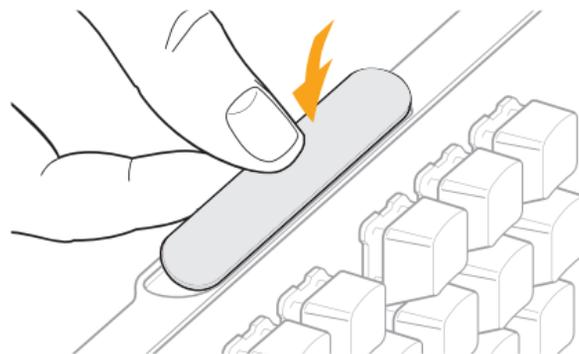
Pentru a instala placa de semnătură, asigurați partea superioară a plăcii în carcasă și apoi apăsați restul plăcii.
