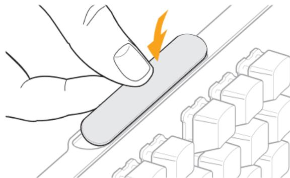
Per installare la piastra di posizionamento, posiziona la porzione superiore nel alloggiamento e allora premi il resto della piastra dentro.
