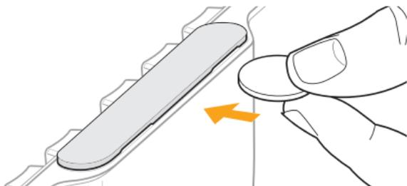
Um das Unterschriftsschild zu entfernen, ziehe einfach das Schild von der unteren Lippe mit einem Fingernagel, einer Münze oder einem anderen dünnen Gerät ab.
