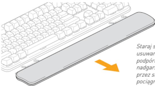
*Staraj się unikać usuwania podpórki dla nadgarstki przez silne pociągnięcie.*
