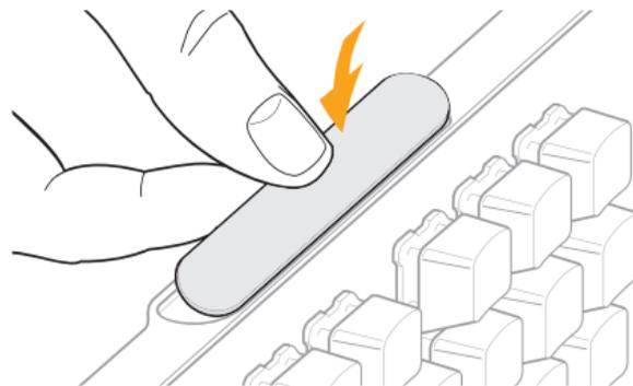
シグネチャープレートを取り付けるには、上部を枠に固定して、残りの部分を押し込みます。
