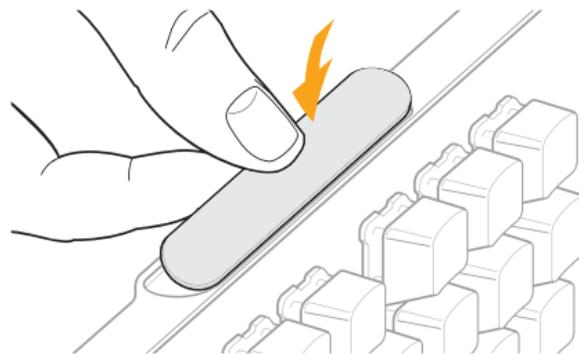
Pour poser la plaque de signature, insérer la partie supérieure de la plaque dans le boîtier et enfoncer ensuite le reste de la plaque dans son emplacement.
