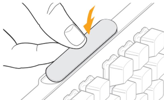
Για να τοποθετήσετε την πλάκα υπογραφής, ασφαλίστε το άνω τμήμα της πλάκας στο περίβλημα και στη συνέχεια, πιέστε το υπόλοιπο της πλάκας μέσα.
