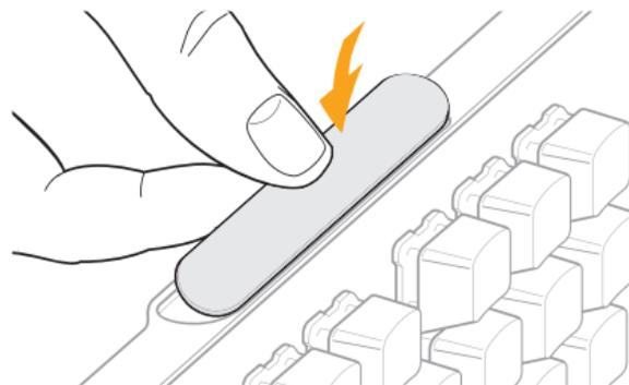
Żeby zainstalować płyty podpisu, zabezpiecz górną część płyty do obudowy i wtedy naciśnij resztę płyty.
