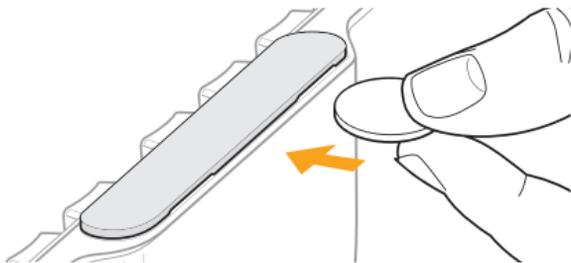
Чтобы извлечь таблички для подписи, просто вытащите ее из нижнего выступа, используя ноготь, монету или другой тонкий инструмент.
