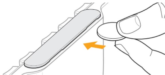
Per rimuovere la piastra di posizionamento, semplicemente stacchi la piastra da sotto con l'unghia o usando la moneta o altra cosa sottile.
