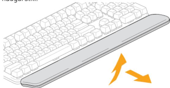
Odtóż to na jednej z dwóch opcji rozszerzenia dostępnych w aluminiowej perforowanej części dolnej.
