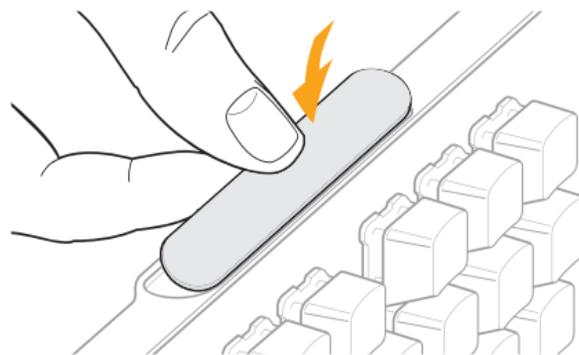
Para instalar la placa de firma, asegúrate de que la parte superior de la placa esté en la carcasa y luego presiona el resto de la placa para dentro.
