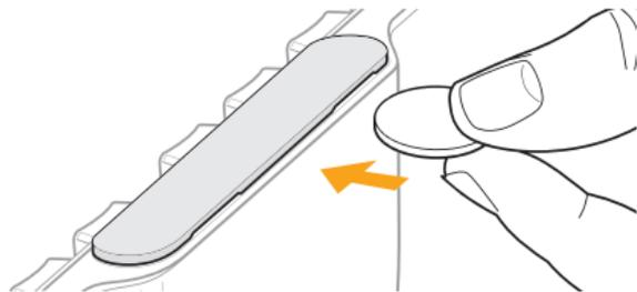
Pentru a elimina placa de semnătură, trageți pur și simplu placa de pe buza inferioară folosind o unghie, o monedă sau alt aparat subțire.
